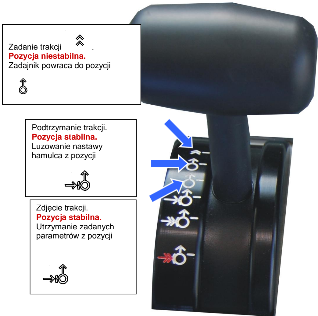
Rysunek 25. Zadajnik jazdy i hamowania
