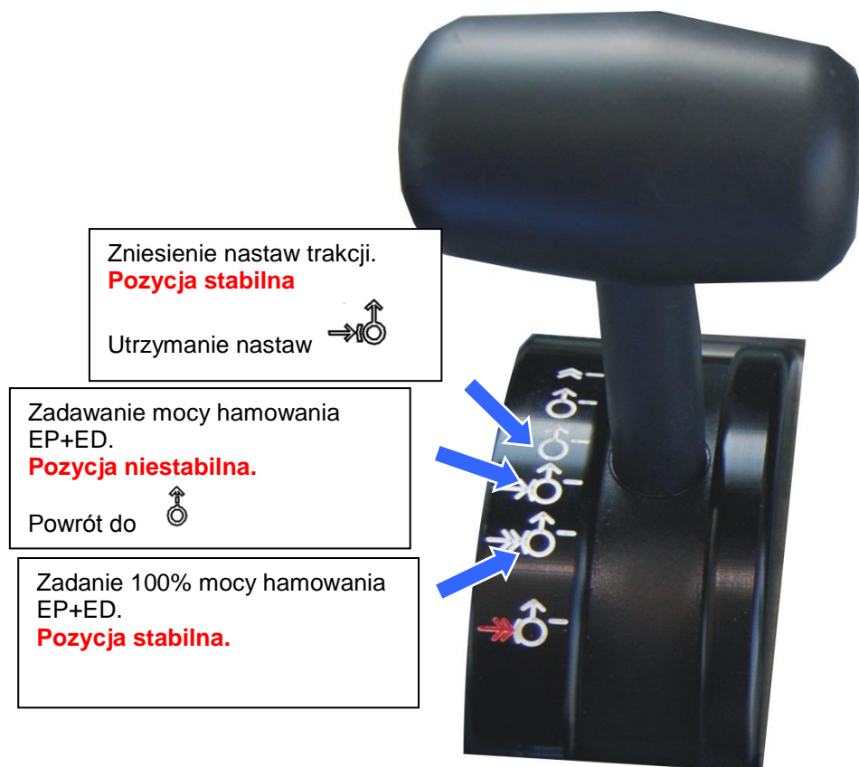
Rysunek 29. Zadajnik jazdy i hamowania
